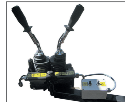
On/Off-Spezialsteuerung (4 Sektionen am Traktor, 4 Sektionen fest am Kran, großer Gewichtsvorteil)
