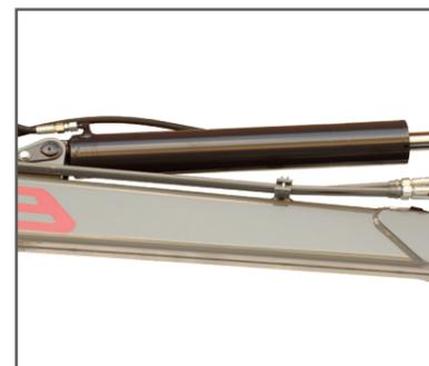
Schlauchbruchventil bei Knickarm, Hauptarm und Abstützung
