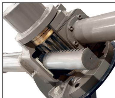
Robuste Zahnstangen mit 80 mm Durchmesser
