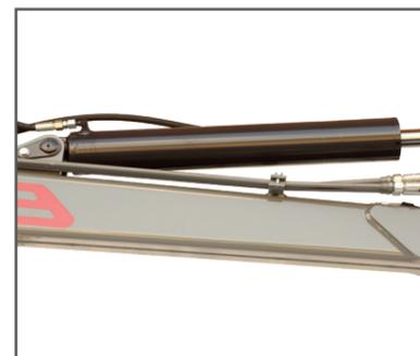
Schlauchbruchventil bei Knickarm, Hauptarm und Abstützung
