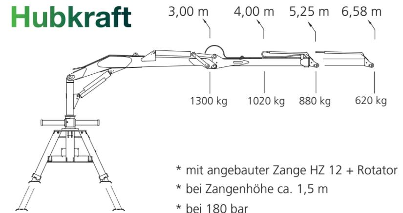
\* mit angebauter Zange HZ 12 + Rotator
