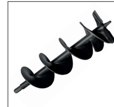
Erdbohrer mit Flügelschneiden (Schneiden und Bohrspitze auswechselbar), Nutzlänge 1.000 mm, Bohrkopf 2-schneidig und gepanzert
