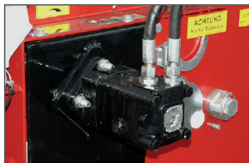
Hydraulischer Antrieb - lose (Erstmontage ca. 2 Stunden)
